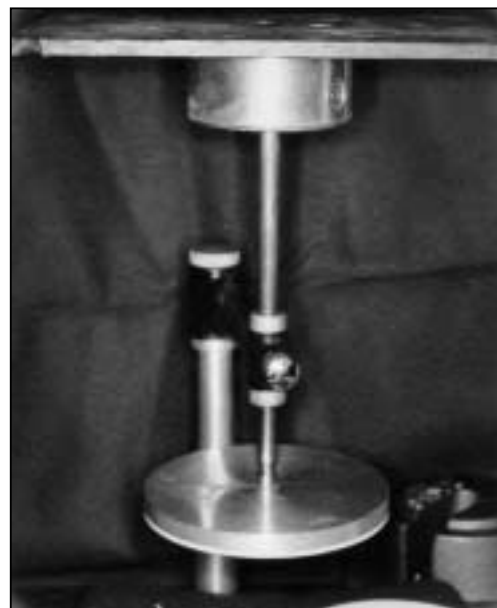
Εικ. 1. Η ιδιοκατασκευή που χρησιμοποιήθηκε για τη μέτρηση της ρευστότητας.
